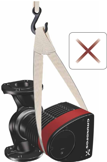
Fig. 6 Izado incorrecto de la bomba
