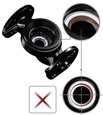
Sistema de sellado centrado incorrectamente
