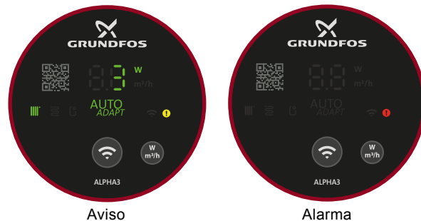
Fig. 36 Indicaciones de aviso y alarma en el panel de control
