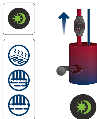
Fig. 21 Condiciones de activación del modo nocturno automático
