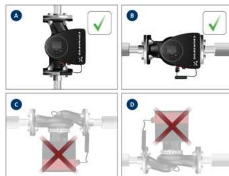
Bomba instalada con el eje del motor en posición horizontal
